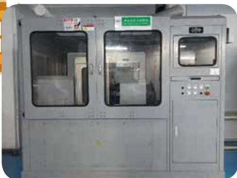
碟盤熱應力試驗機
