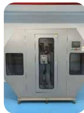
人機型碟盤衝擊試驗機
